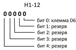
[бит = 0]: Функция активируется при замыкании клеммы (NO контакт).
