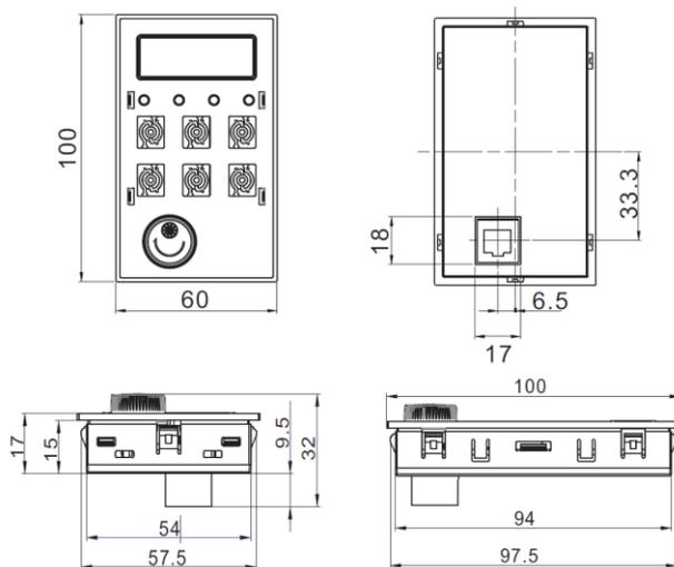
Разметка отверстия для монтажа
