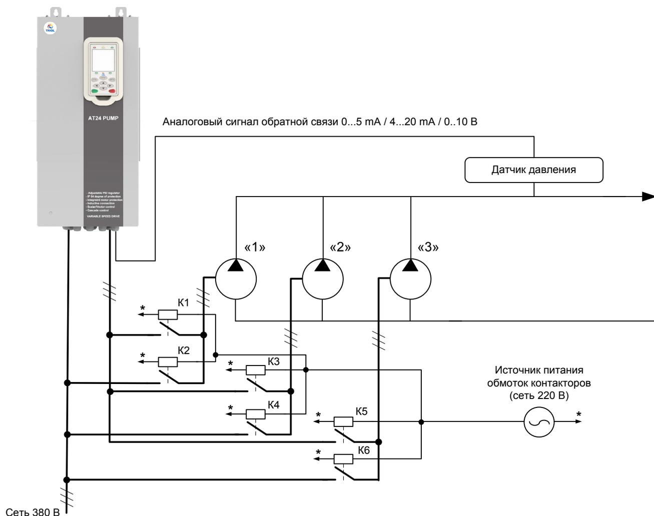
\* – к релейным (дискретным) выходам электропривода AT24 PUMP
