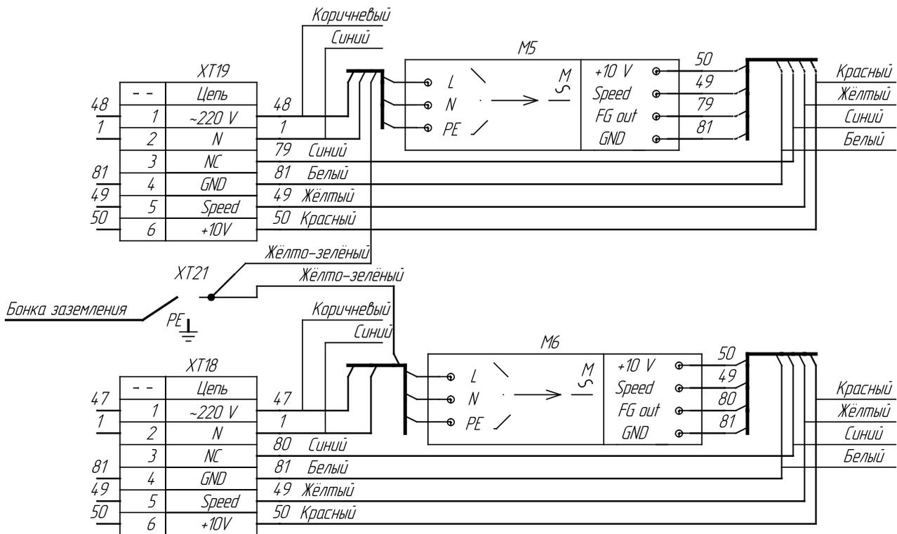
**Рисунок 14.10 — Схема подключения вентиляторов в электроприводах моделей АТ24-М25...М32-380-Н\*\*\*\*.**
