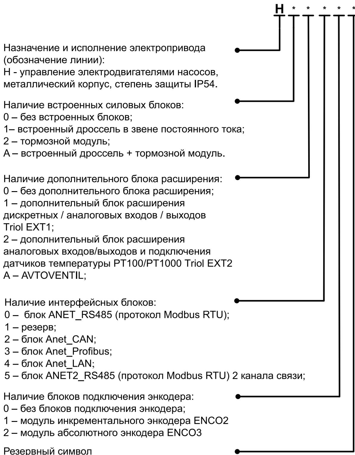
**Примечание.** При конфигурации «AVTOVENTIL» (H\*A\*\*\*) электропривод поставляется только без встроенного тормозного модуля, так как функционально он не используется.
