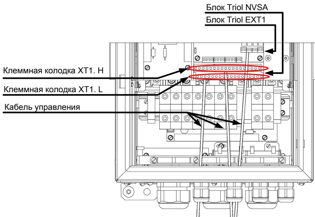
*Примечание. В качестве примера на рисунке изображено подключение проводников цепей управления к электроприводу AT24-15к-380-Н\*\*\*\*\**
