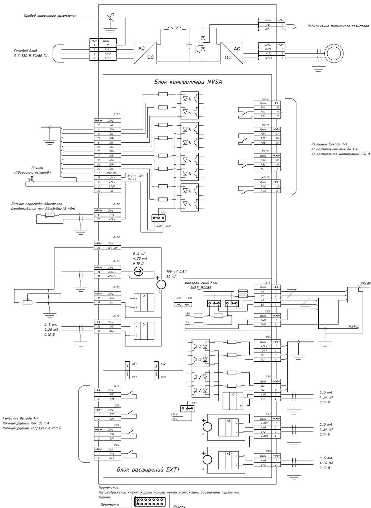
Рисунок 6.14 — Общая схема внешних подключений электроприводов серии Триол AT24-15K...55K-380-НА\*\*\*\*
