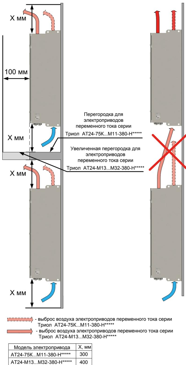
**Рисунок 4.10 — Установка перегородки**
