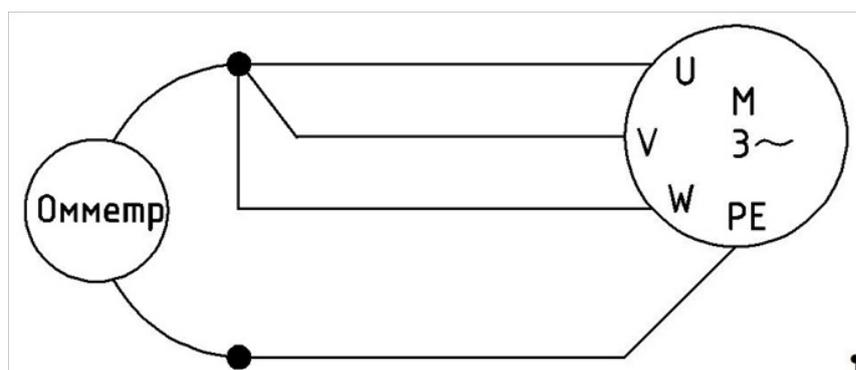
Рисунок 5.7 — Схема подключения мегомметра к двигателю
