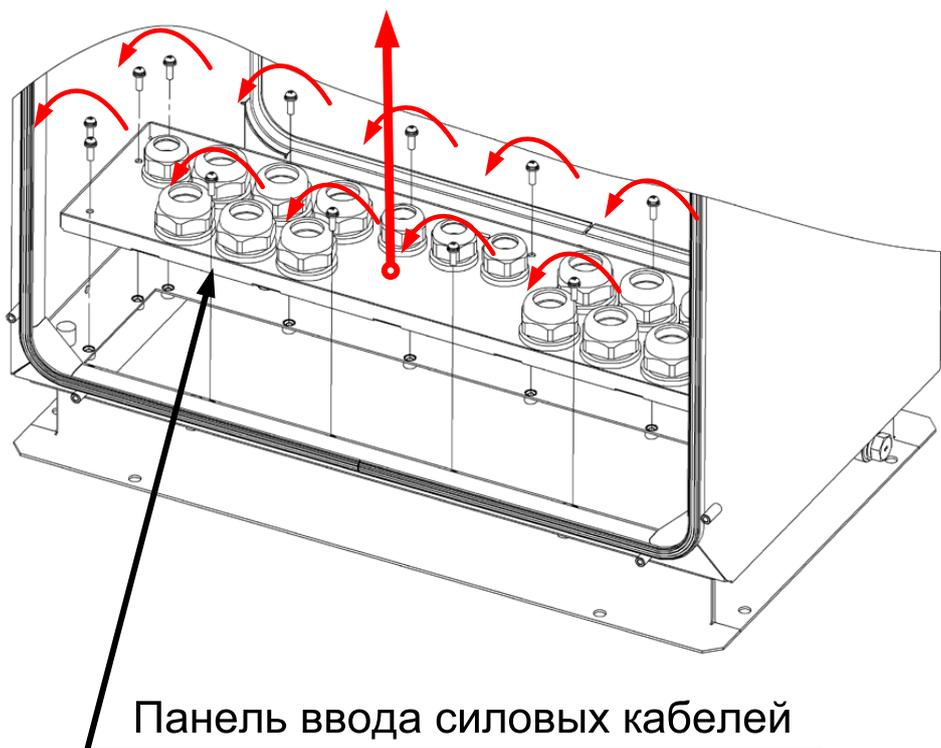
**Рисунок 5.37 — Демонтаж панели ввода силовых кабелей**
