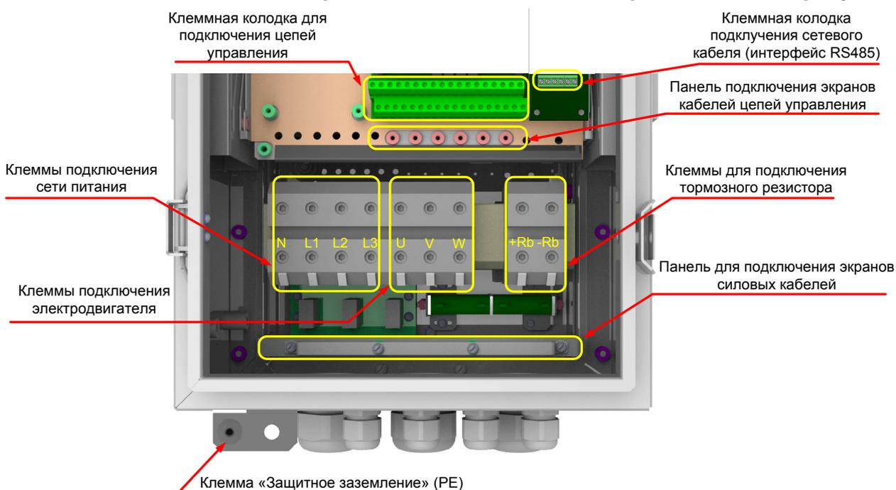
**Рисунок 5.9 — Расположение и назначение клемм электроприводов серии Триол AT24-15K...55K-380-H\*\*\*\***
