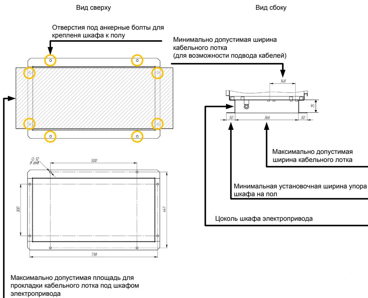
**Рисунок 5.35 — Расположение электропривода над кабелепроводом**
