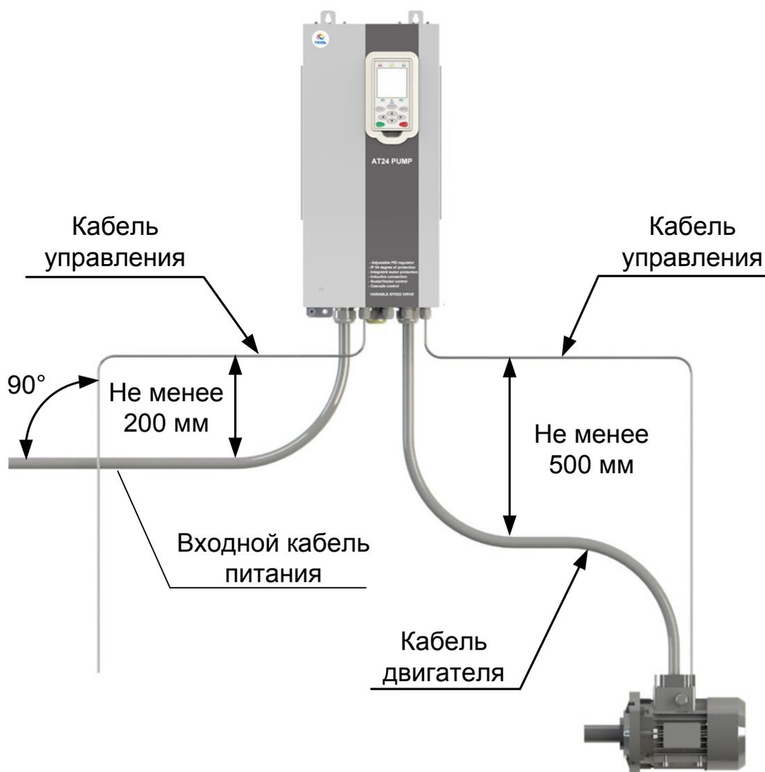
Рисунок 12.4 — Схема прокладки сетевого кабеля
