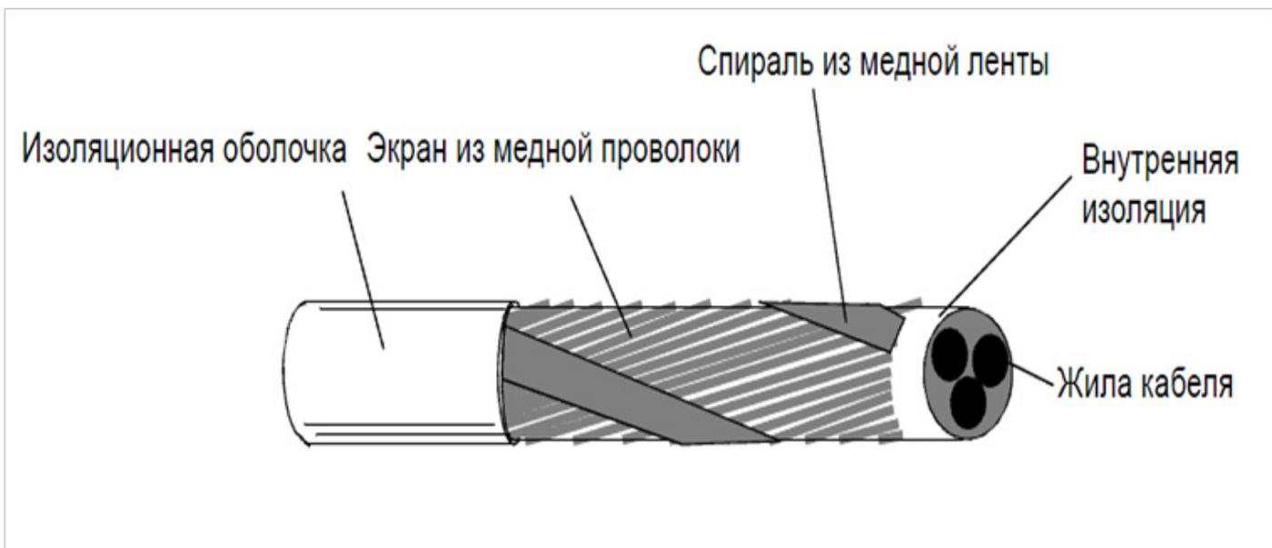
Рисунок 4.17 — Кабель двигателя
