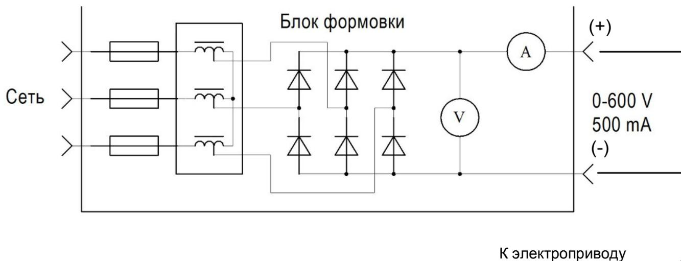
**Рисунок 4.1 — Схема устройства для формования конденсаторов ЗПТ**
