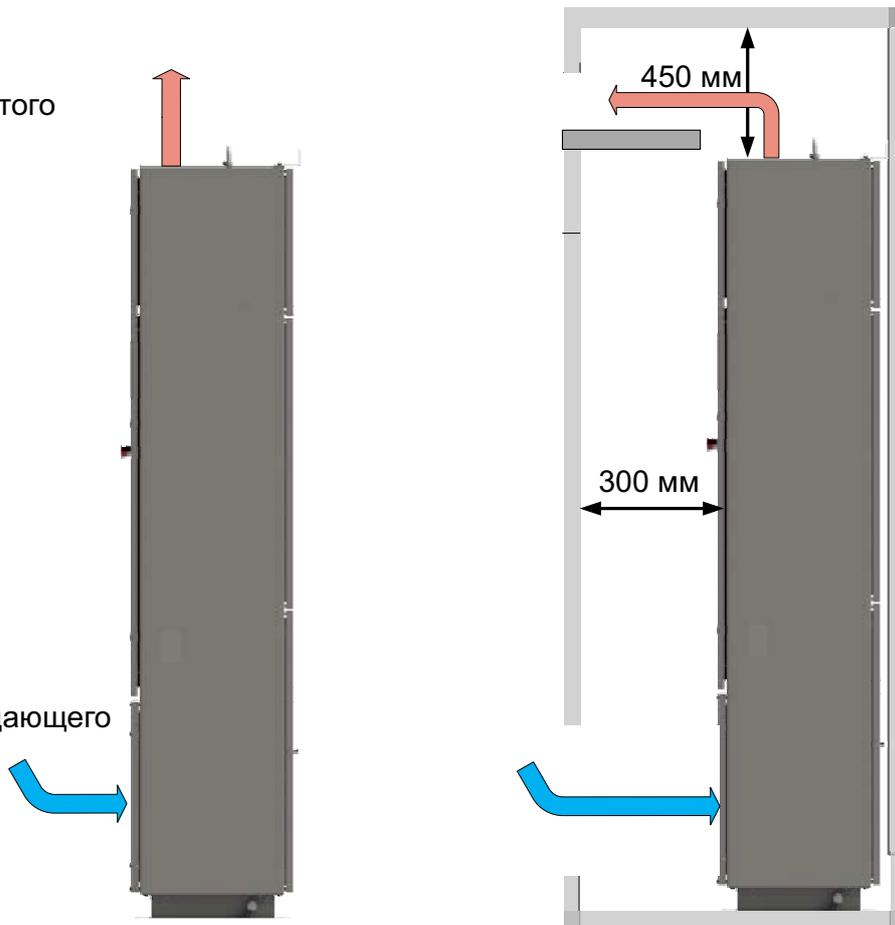
**Рисунок 4.15 – Направление потока охлаждающего воздуха электроприводов серии Триол AT24-M40-380-H\*\*\*\*\***
