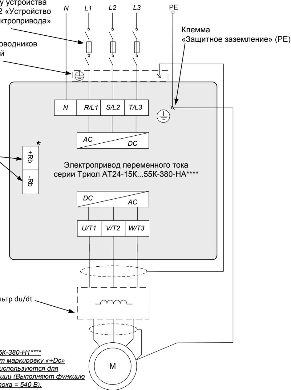
**Рисунок 5.16 — Схема подключения силовых кабелей электроприводов серии Триол АТ24-15К...55К-380-Н\*\*\*\*\* при использовании нейтрали**
