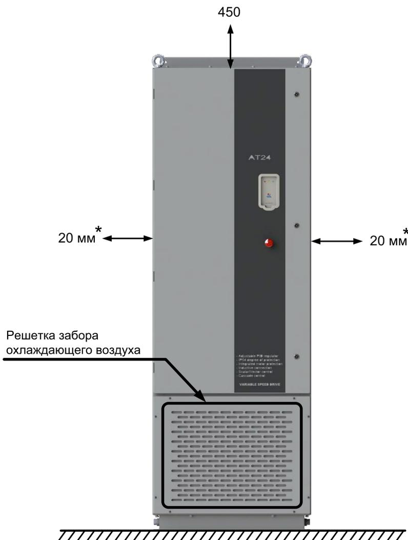
*\*Примечание: Указанный зазор необходим для подключения Проводника заземления к банкам, которые расположены на боковых сторонах цоколя электропривода. По этому при размещении в углу помещения допускается установка вплотную к стене.*
