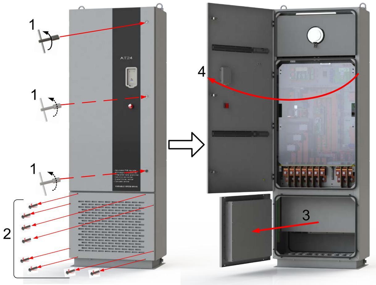
**Рисунок 5.36 — Открытие двери и снятие панели основания**
