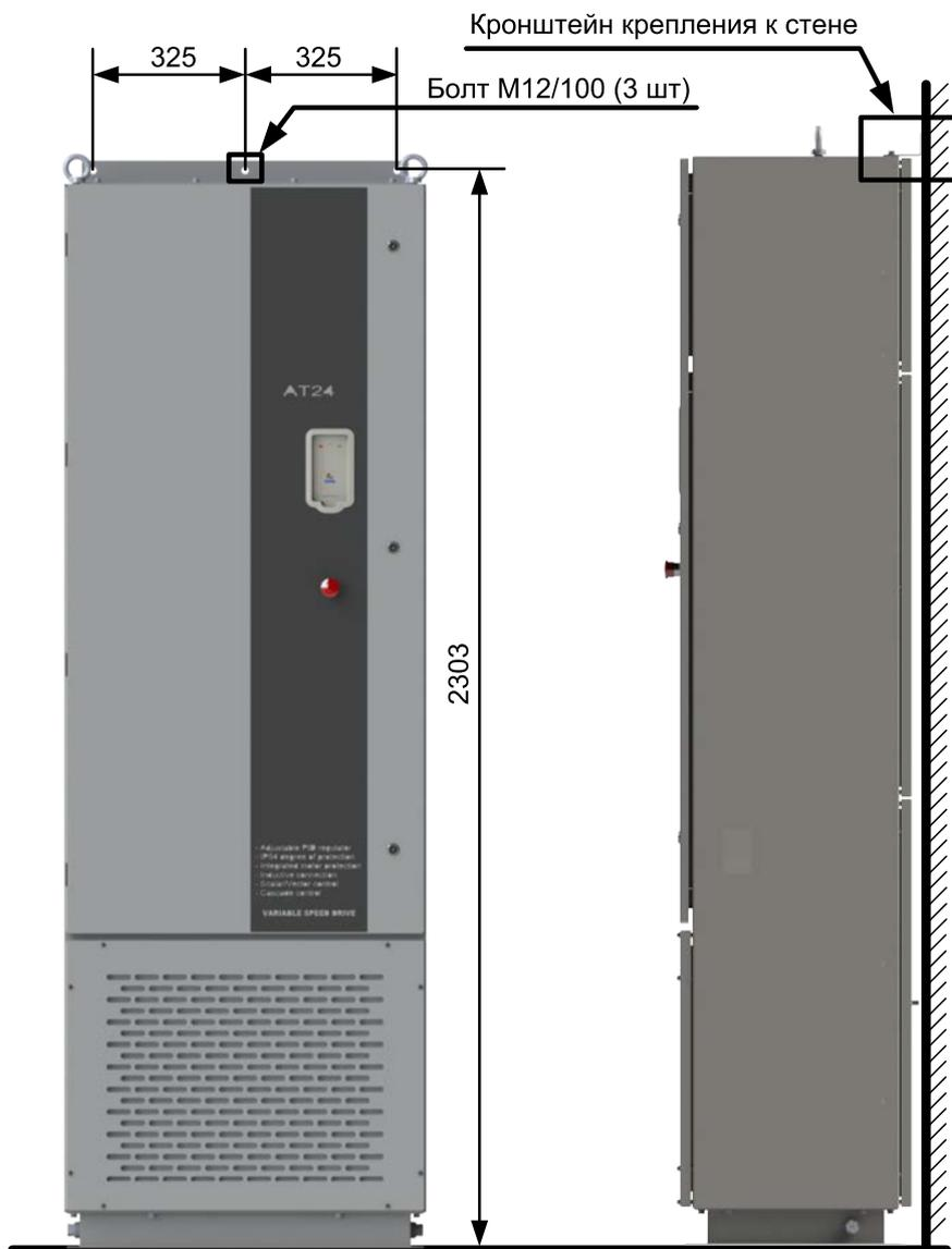
**Рисунок 5.38 — Крепление шкафа к стене**
