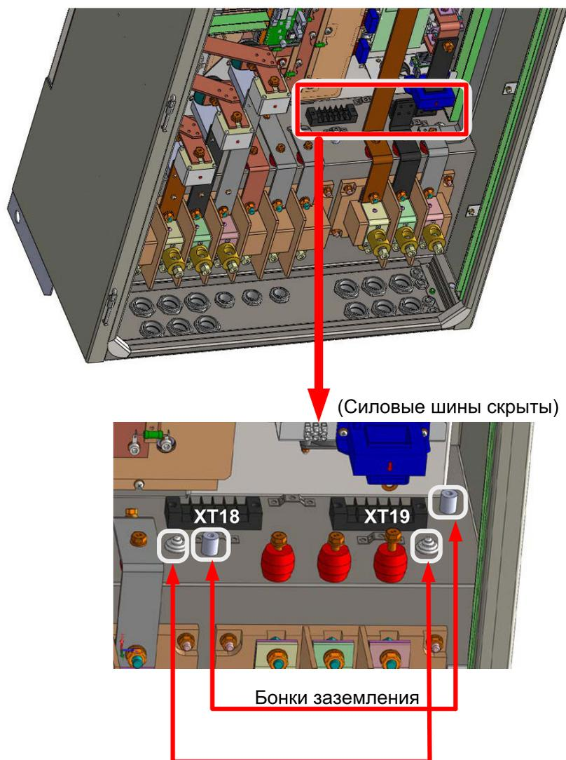
**Рисунок 14.9 — Расположение клемм подключения вентиляторов в электроприводах моделей АТ24-М25...М32-380-Н\*\*\*\*\*.**
