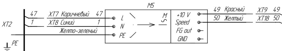
**Рисунок 14.11 — Схема подключения вентилятора в электроприводах моделей АТ24-М13...М20-380-Н\*\*\*\*.**
