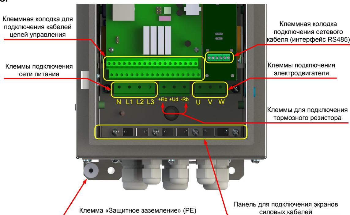
Клеммы +Rb и +Ud также используются для подключения внутреннего дросселя звена постоянного тока.
