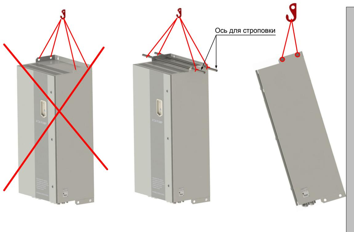
Рисунок 5.2 — Строповка электропривода АТ24-75К...М20-380-Н\*\*\*\*\*
