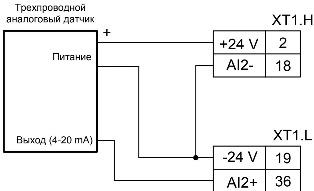
**Рисунок 6.4 — Трехпроводная схема подключения аналогового датчика**
