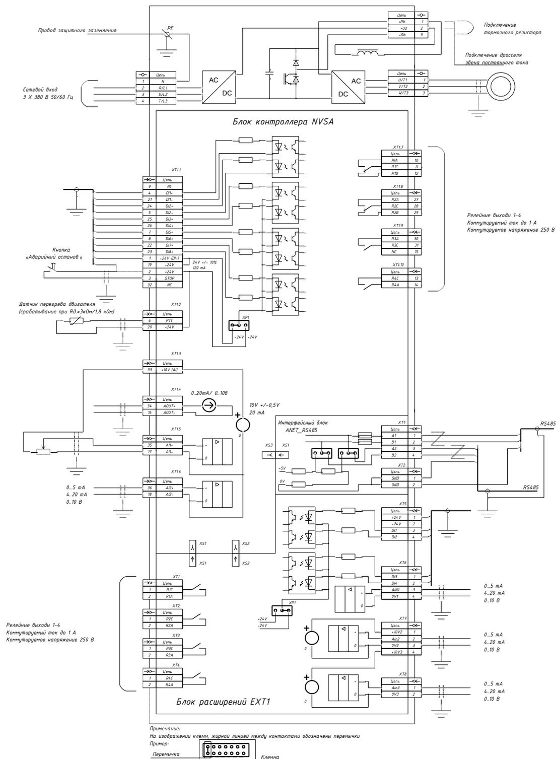
Рисунок 6.13 — Общая схема внешних подключений электроприводов серии Триол AT24-5K5...11K-380-Н\*\*\*\*\*
