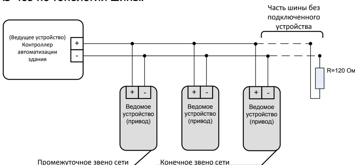
Рисунок 12.3 — Схема построения сети на основе интерфейса RS-485
