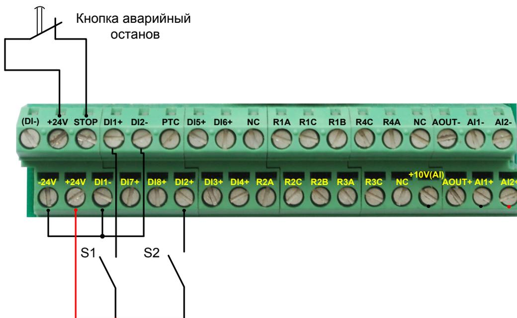
**Рисунок 8.1 — Подключение цепей управления. «Двухпроводное управление двигателем»**
