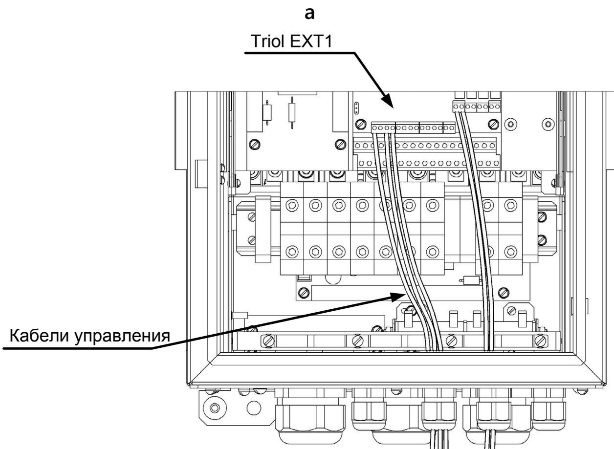
*Примечание. В качестве примера на рисунке изображена установка блока Triol EXT1 и подключенные кабели управления электропривода АТ24-15к-380-Н\*\*\*\**
