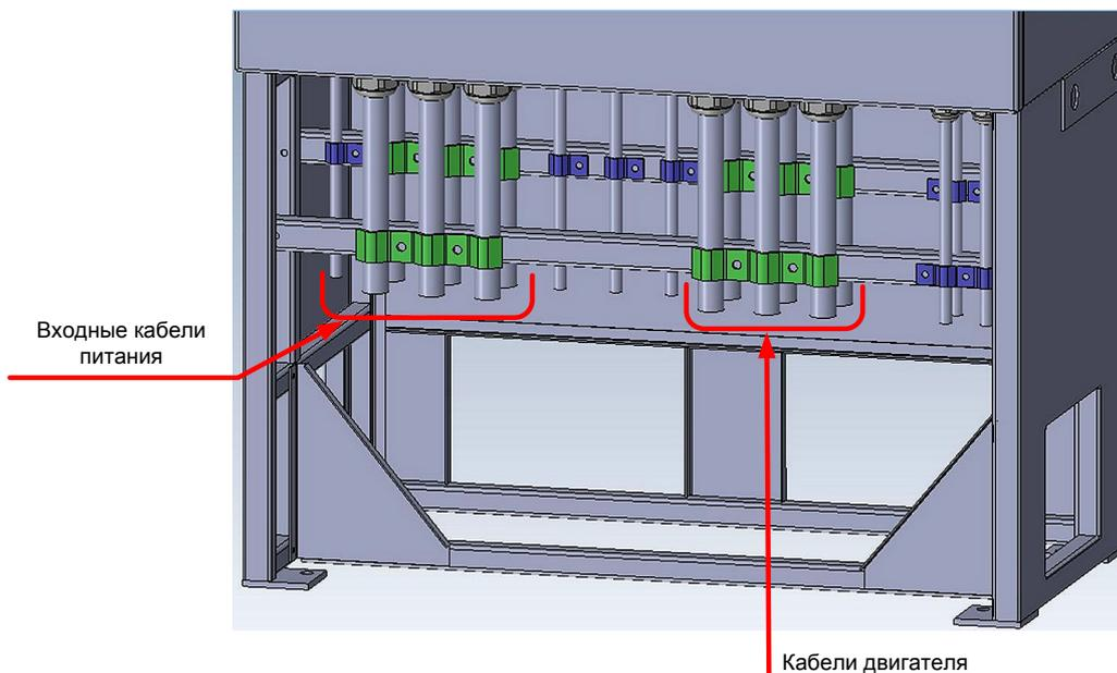
**Рисунок 5.33 — Монтаж силовых кабелей AT24-M13. . .M32-380-H\*\*\*\*\***
