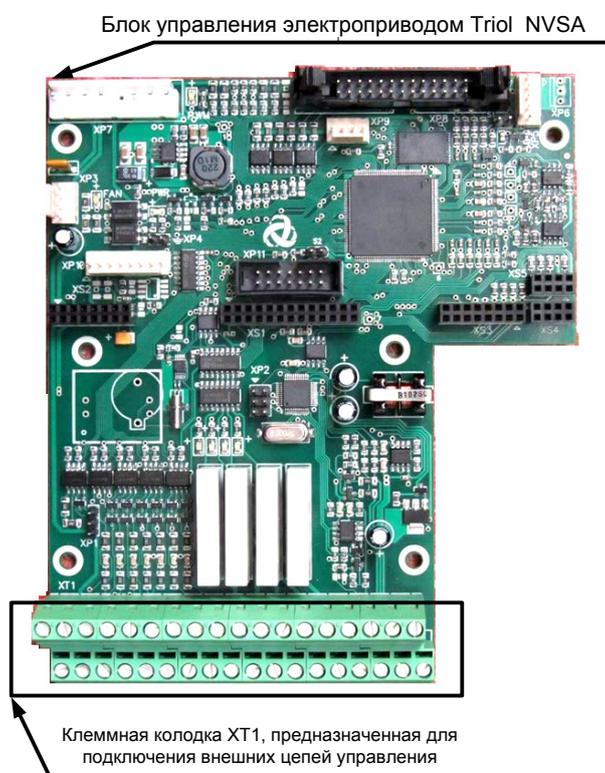
Рисунок 6.1 — Внешний вид блока Triol NVSA
