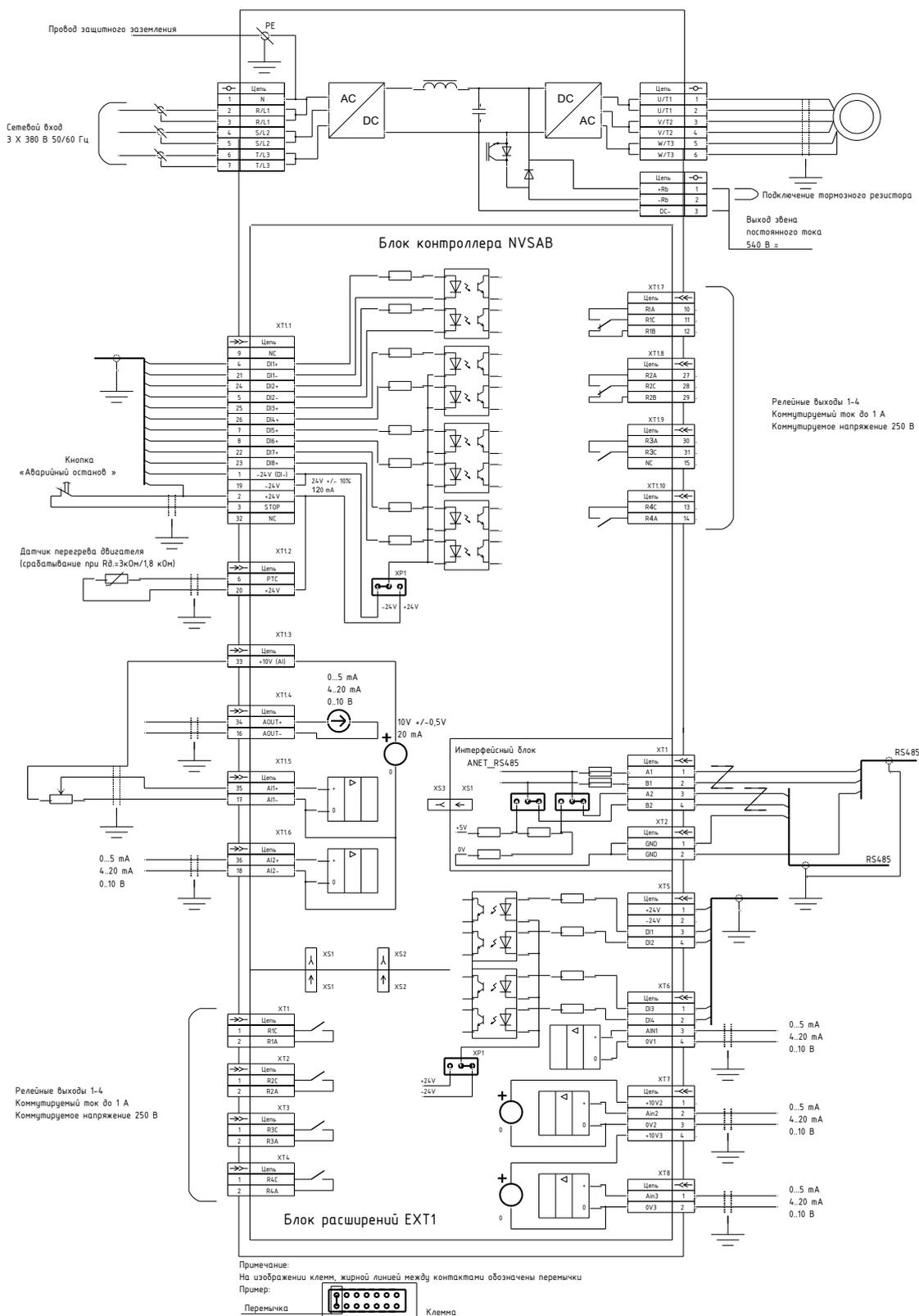
**Рисунок 6.16 — Общая схема внешних подключений электроприводов серии Триол AT24-M13...M32-380-НА\*\*\*\***
