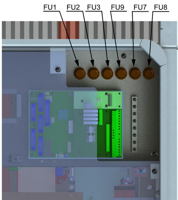
**FU1** — предохранитель в цепи питания системы управления 220 В переменного тока (ПК45-5 А);
