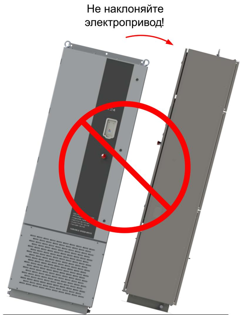
Данная модель электропривода рассчитана только на напольный монтаж. Подвод силовых кабелей к данной модели электропривода выполняется только снизу (с кабелепровода). Для возможности подвода кабелей без наличия кабелепровода электропривод необходимо устанавливать на металлическую раму, которая обеспечит подвод кабелей сзади или с боку электропривода.
