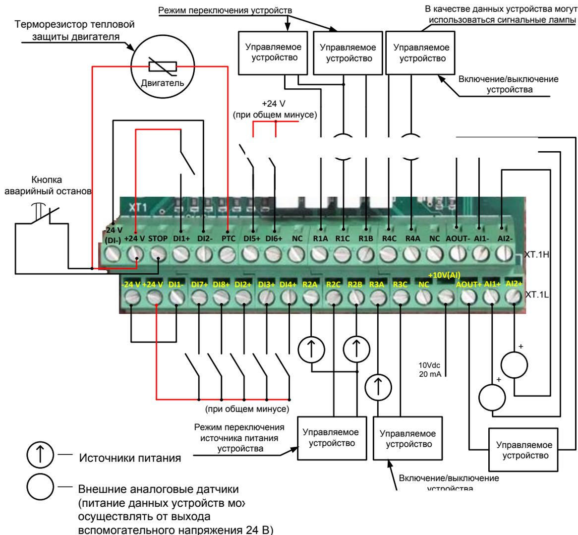
**Рисунок 6.2 — Подключение внешних цепей управления к блоку Triol NVSA**
