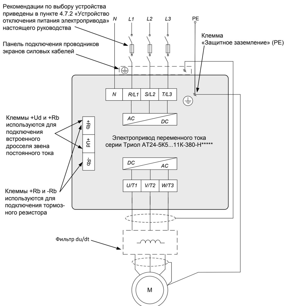
**Рисунок 5.15** — Схема подключения силовых кабелей электроприводов серии Триол АТ24-5К5...11К-380-Н\*\*\*\*\*
