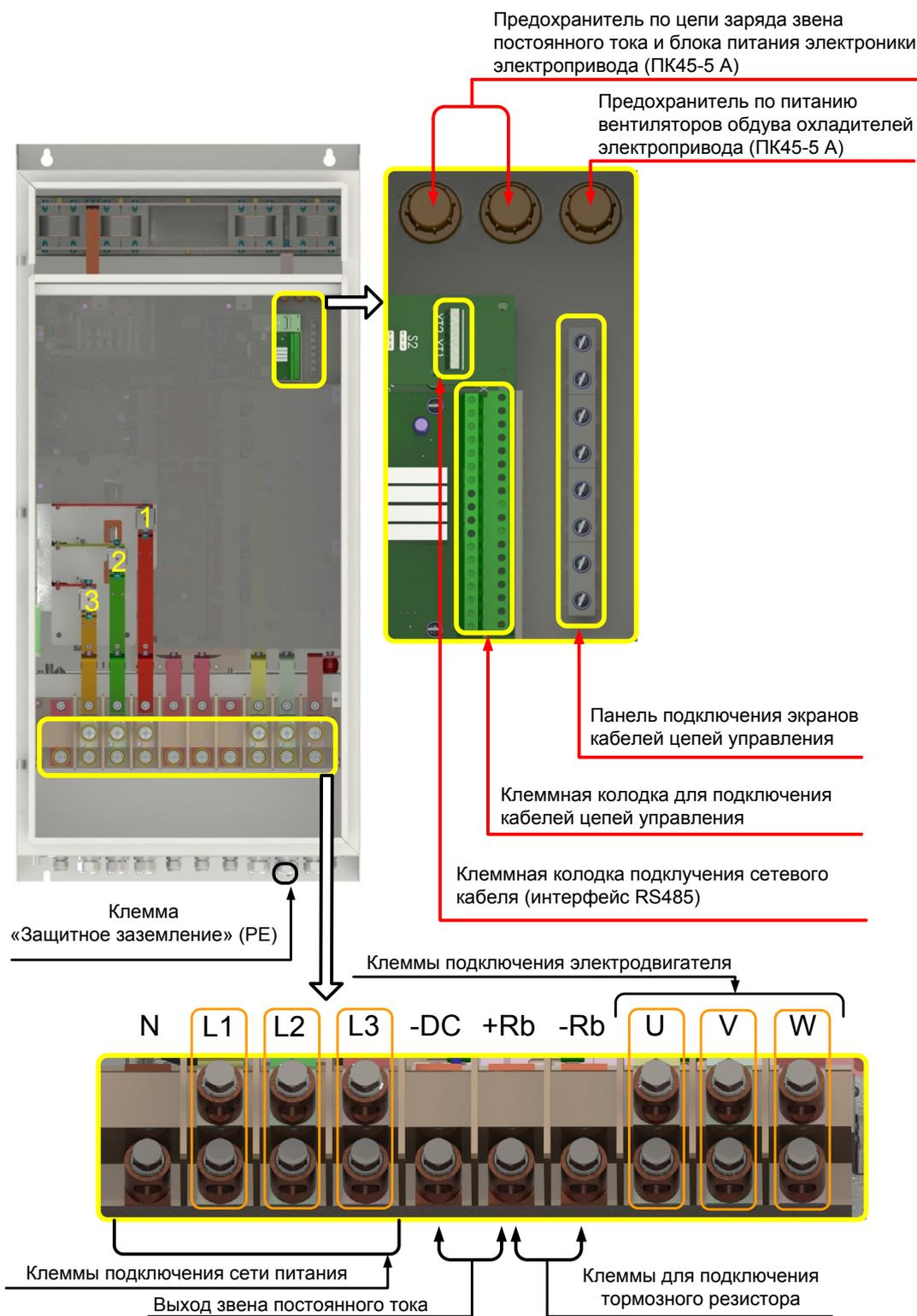
**Рисунок 5.11 — Расположение и назначение клемм электроприводов серии Триол AT24-M13...M32-380-H\*\*\*\***
