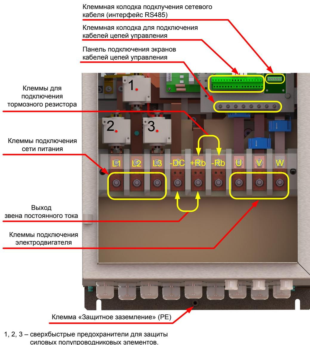
**Рисунок 5.10 — Расположение и назначение клемм электроприводов серии Триол АТ24-75К...М11-380-Н\*\*\*\*\***
