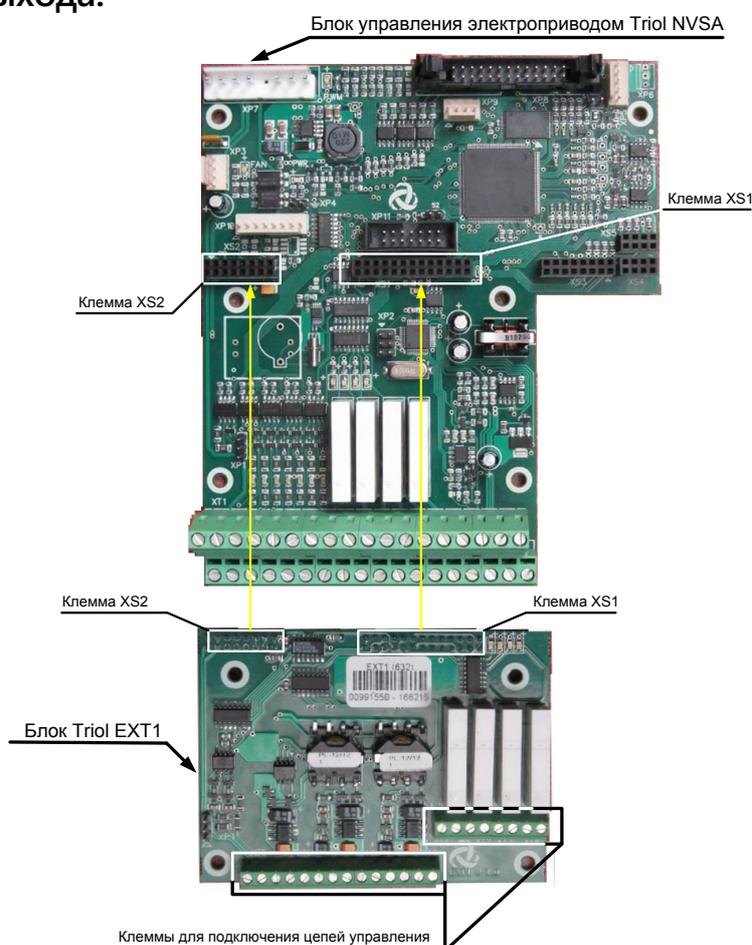
Рисунок 6.7 — Внешний вид блоков Triol EXT1 и Triol NVSA
