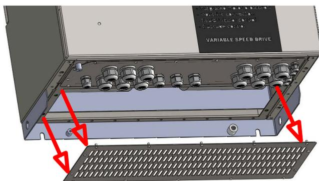
**Рисунок 14.8 — Демонтаж защитной решетки вентиляторов электроприводов моделей АТ24-М13.. .М32-380-Н\*\*\*\*\***
