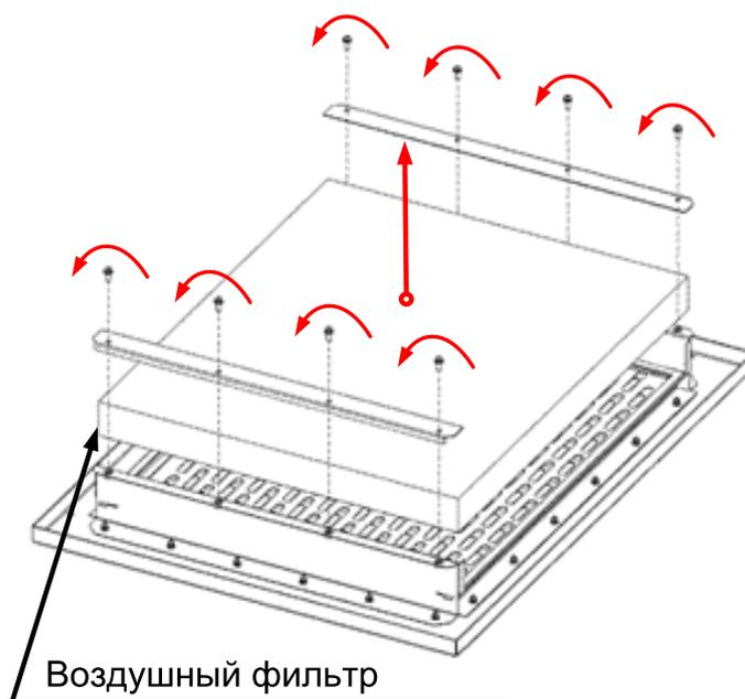
**Рисунок 14.18 — Снятие фильтра с панели основания**
