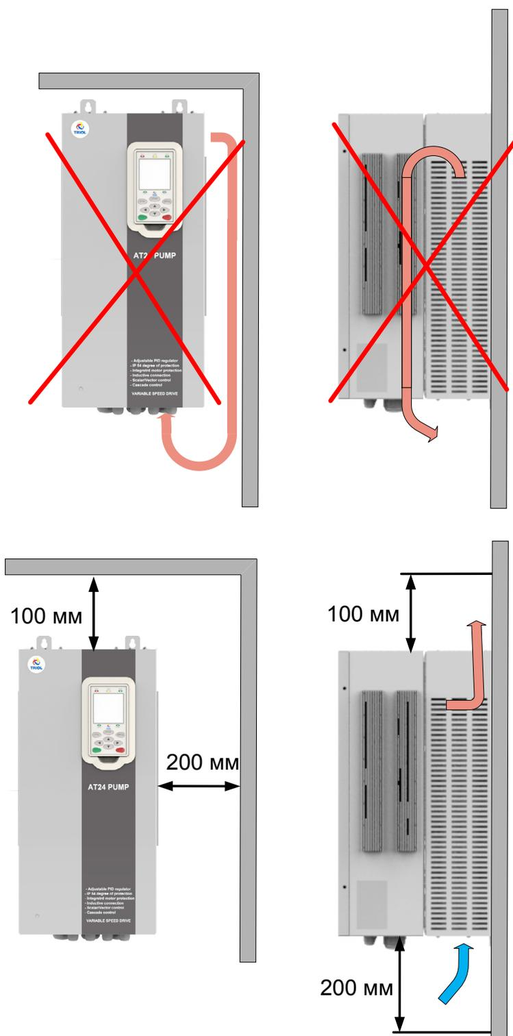
Рисунок 4.6 — Предотвращение рециркуляции горячего воздуха
