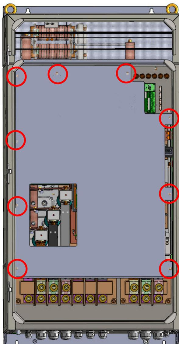
**Рисунок 14.6 — Снятие защитного стекла электроприводов моделей AT24-M13...M32-380-H\*\*\*\*\***
