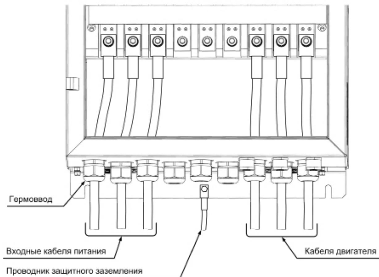
**Рисунок 5.22 — Монтаж силовых кабелей серии Триол АТ24-75К...М11-380-Н\*\*\*\*\***
