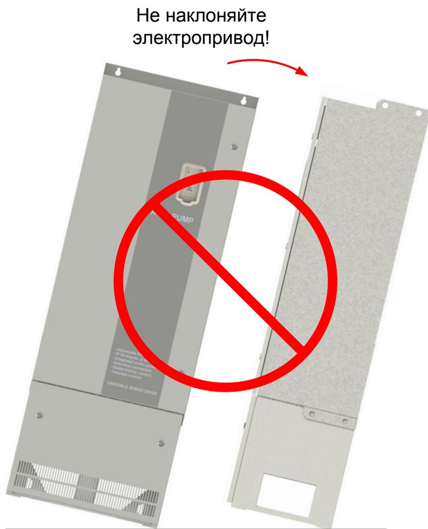
**Последовательность монтажных операций при напольном монтаже электроприводов моделей АТ24-М13...М32-380-Н\*\*\*\*\*:**
