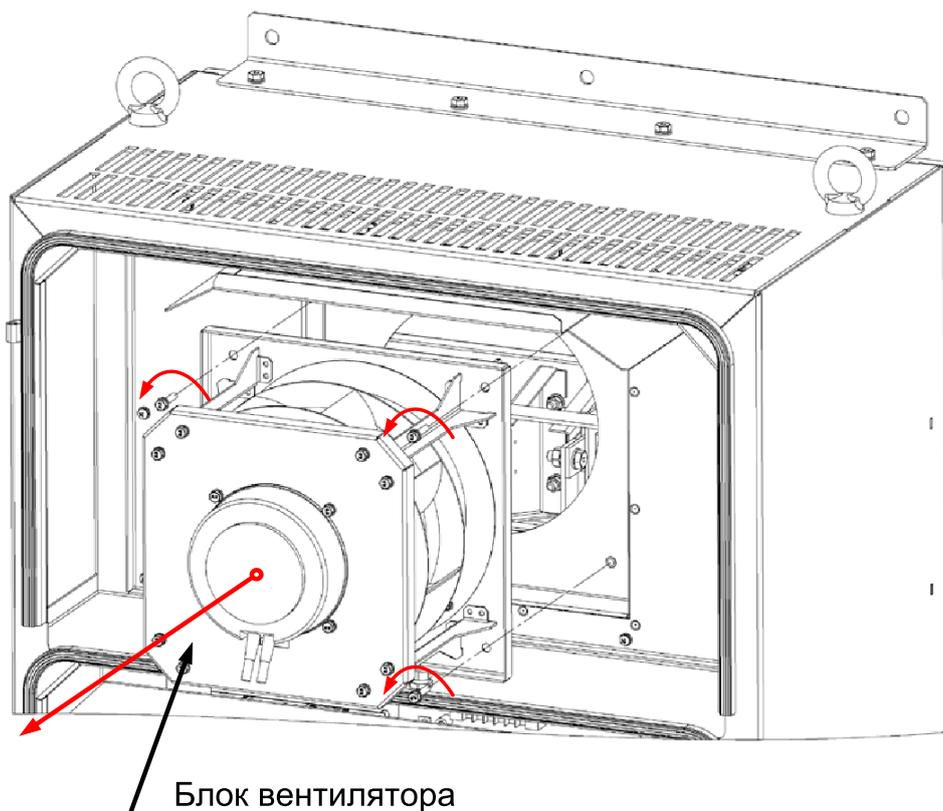
**Рисунок 14.15 — Снятие блока вентилятора.**
