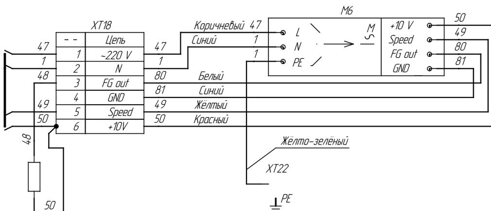
**Рисунок 14.14 — Схема подключения вентилятора в электроприводах моделей АТ24-М40-380-Н\*\*\*\*\*.**
