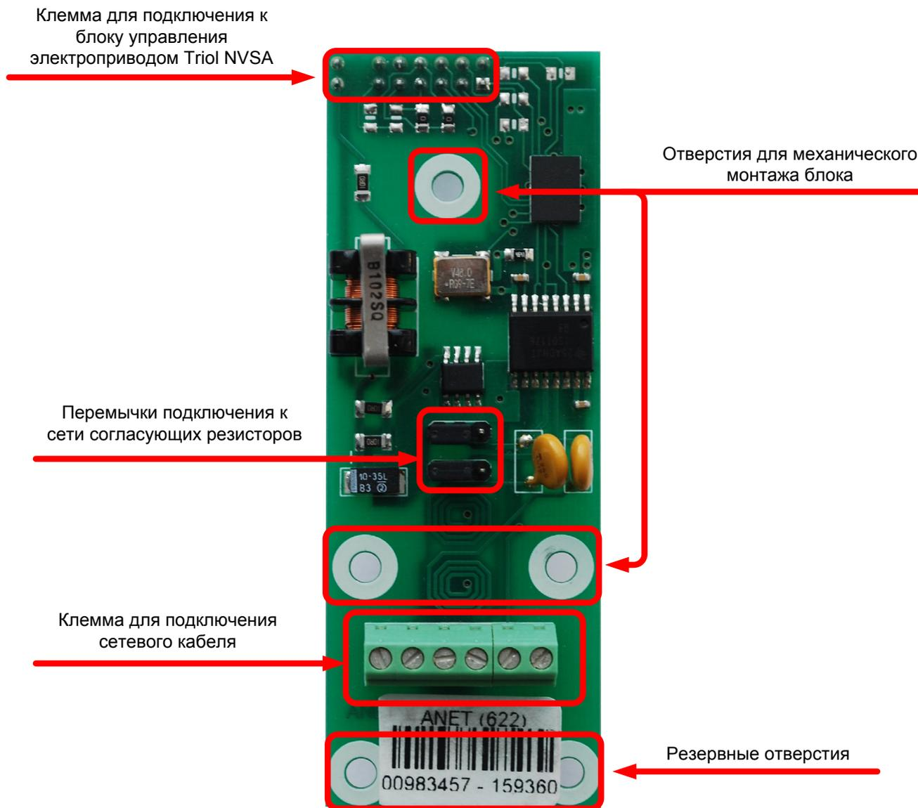
Рисунок 12.1 — Внешний вид интерфейсного блока Triol ANET\_RS-485
