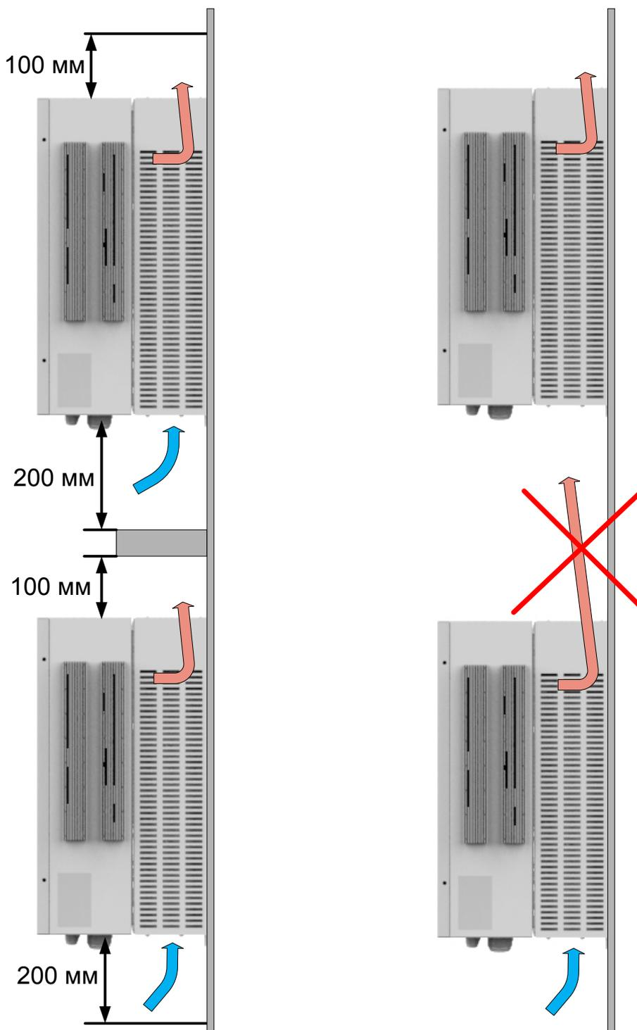
Рисунок 4.7 — Установка перегородки
