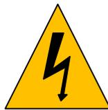
**Символ электрической опасности** — при невыполнении рекомендаций, указанных в предупреждениях с данным символом, возникает опасность поражения обслуживающего персонала электрическим током и/или повреждения оборудования.
