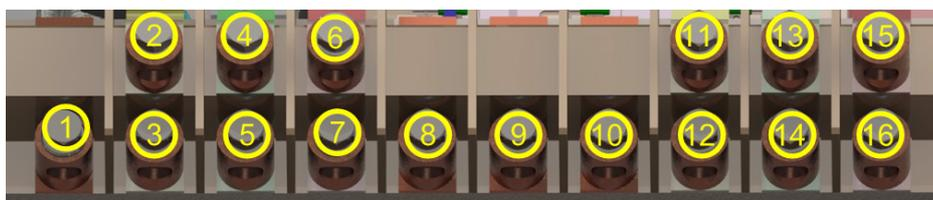
**Рисунок 5.28 — Силовой клеммник электропривода**
