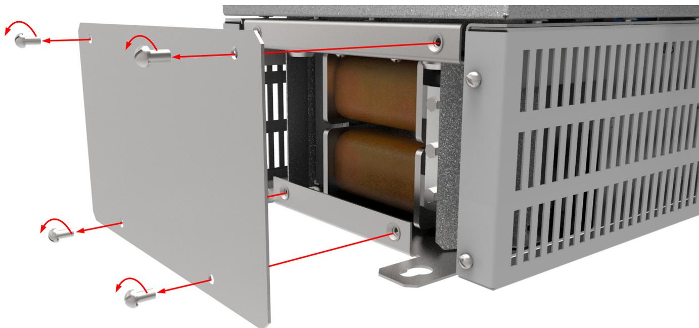
**Рисунок 14.1 — Снятие верхней крышки электроприводов моделей АТ24-5К5...55К-380-Н\*\*\*\*\***
