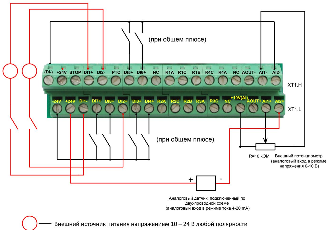
**Рисунок 6.3 — Пример подключение цепей управления к блоку Triol NVSA**
