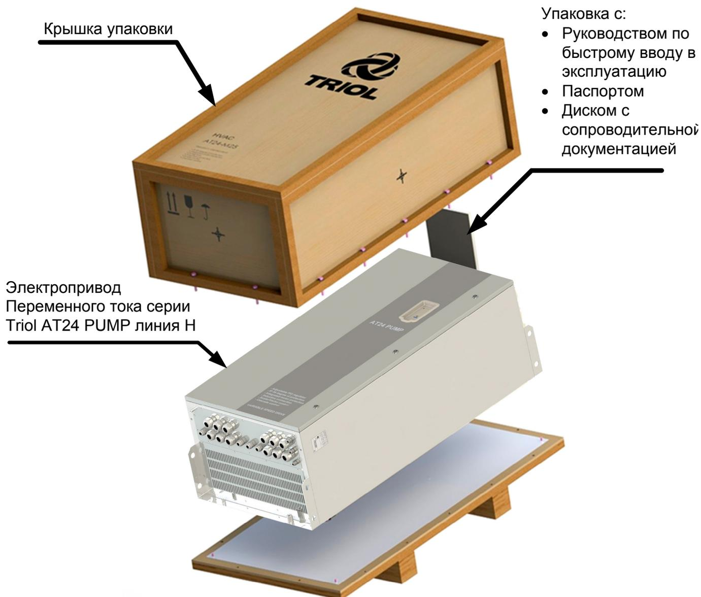
**Рисунок 4.3 — Расположение основных принадлежностей в упаковке электроприводов серии Триол АТ24-15К...М32-380-Н\*\*\*\*\***
