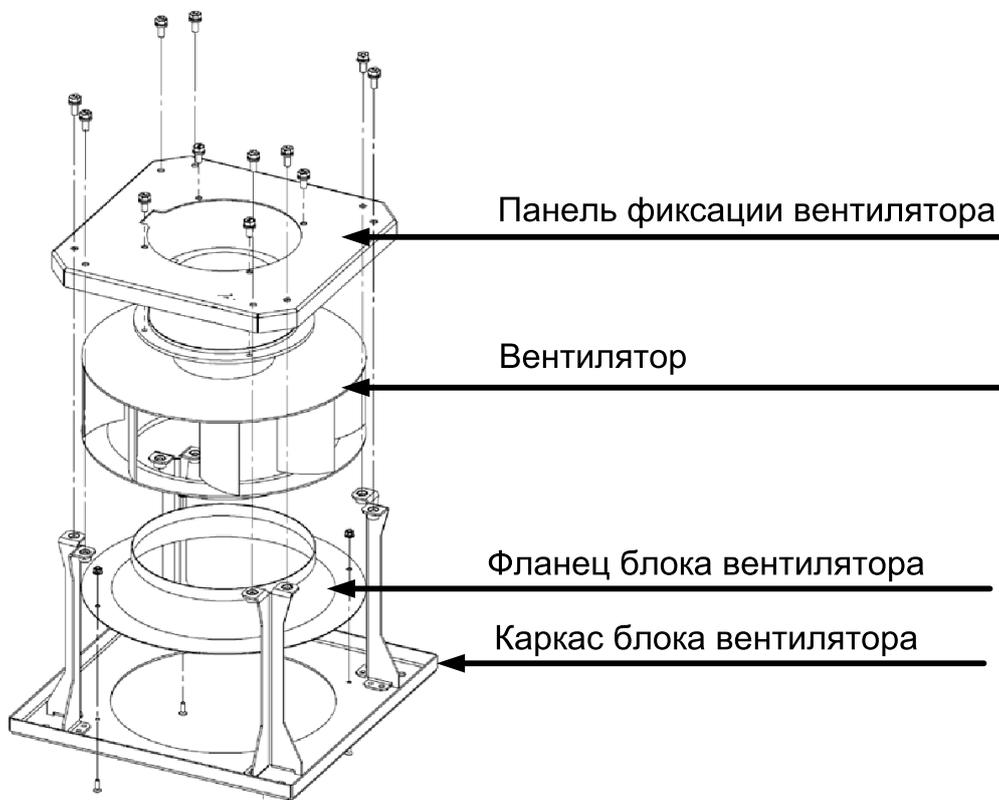
**ПРИМЕЧАНИЕ.** При разборке блока фланец вентилятора с каркаса демонтировать не обязательно.
