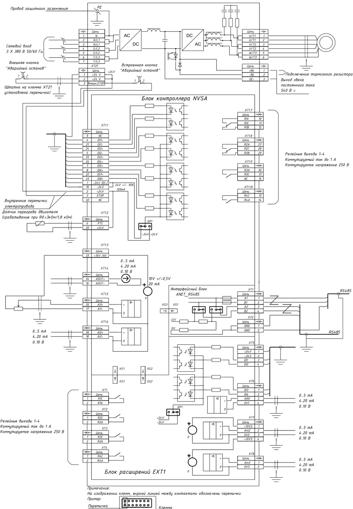
**Рисунок 6.17 — Схема внешних подключений электроприводов переменного тока серии Триол AT24-M40-380-Н\*\*\*\***
