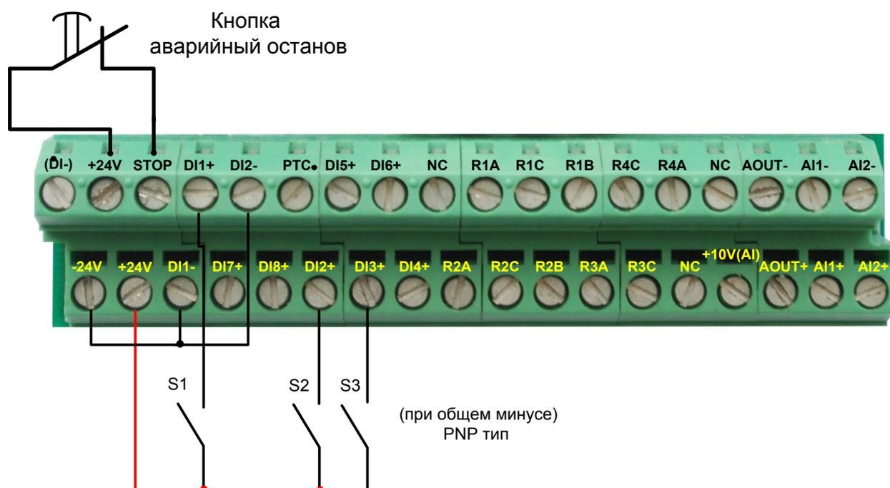
Рисунок 8.2 — Подключение цепей управления. «Трехпроводное управление двигателем»
