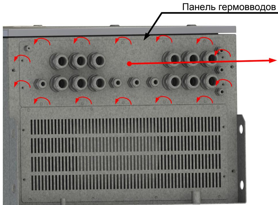
**Рисунок 5.29 — Снятие панели гермовводов**
