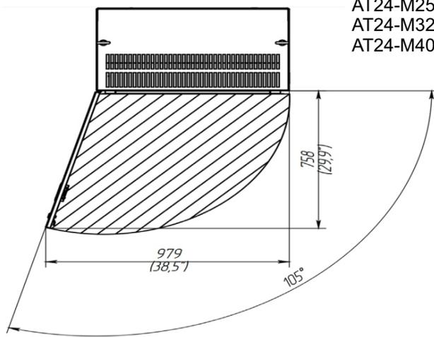
**Рисунок 4.16 — Необходимое пространство перед электроприводами серии Триол AT24-5K5...M40-380-H\*\*\*\*\***
