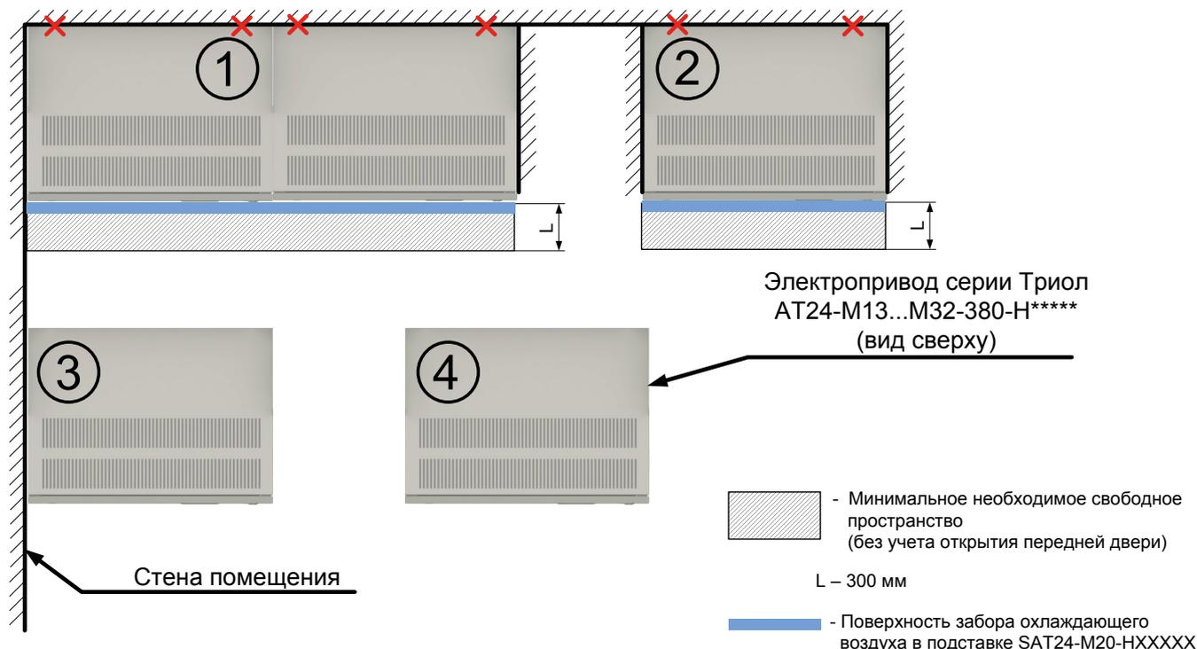
Варианты напольной установки электропривода:
