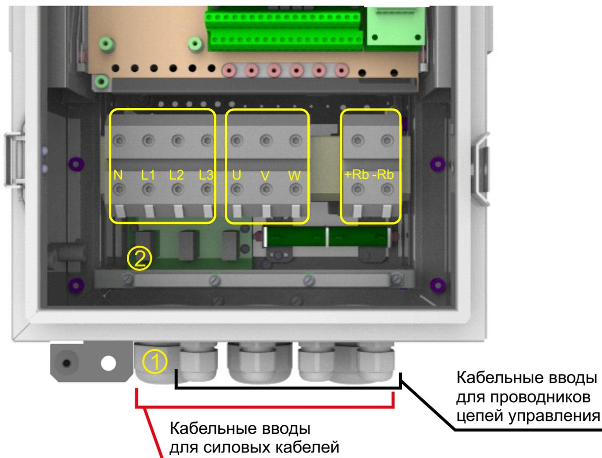
Рисунок 5.20 — Схема подключения силовых кабелей
