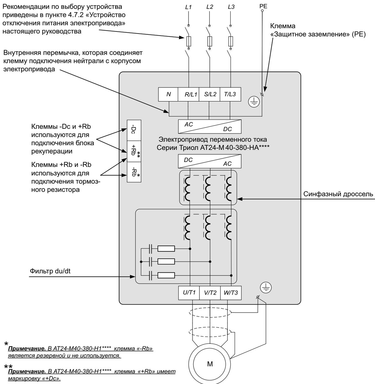
**Рисунок 5.19 — Схема подключения силовых кабелей электроприводов серии Триол АТ24-М40-380-Н\*\*\*\*\***
