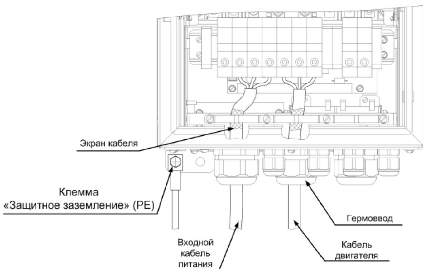
**Рисунок 5.21 — Монтаж силовых кабелей серии Триол АТ24-5К5...55К-380-Н\*\*\*\*\***
