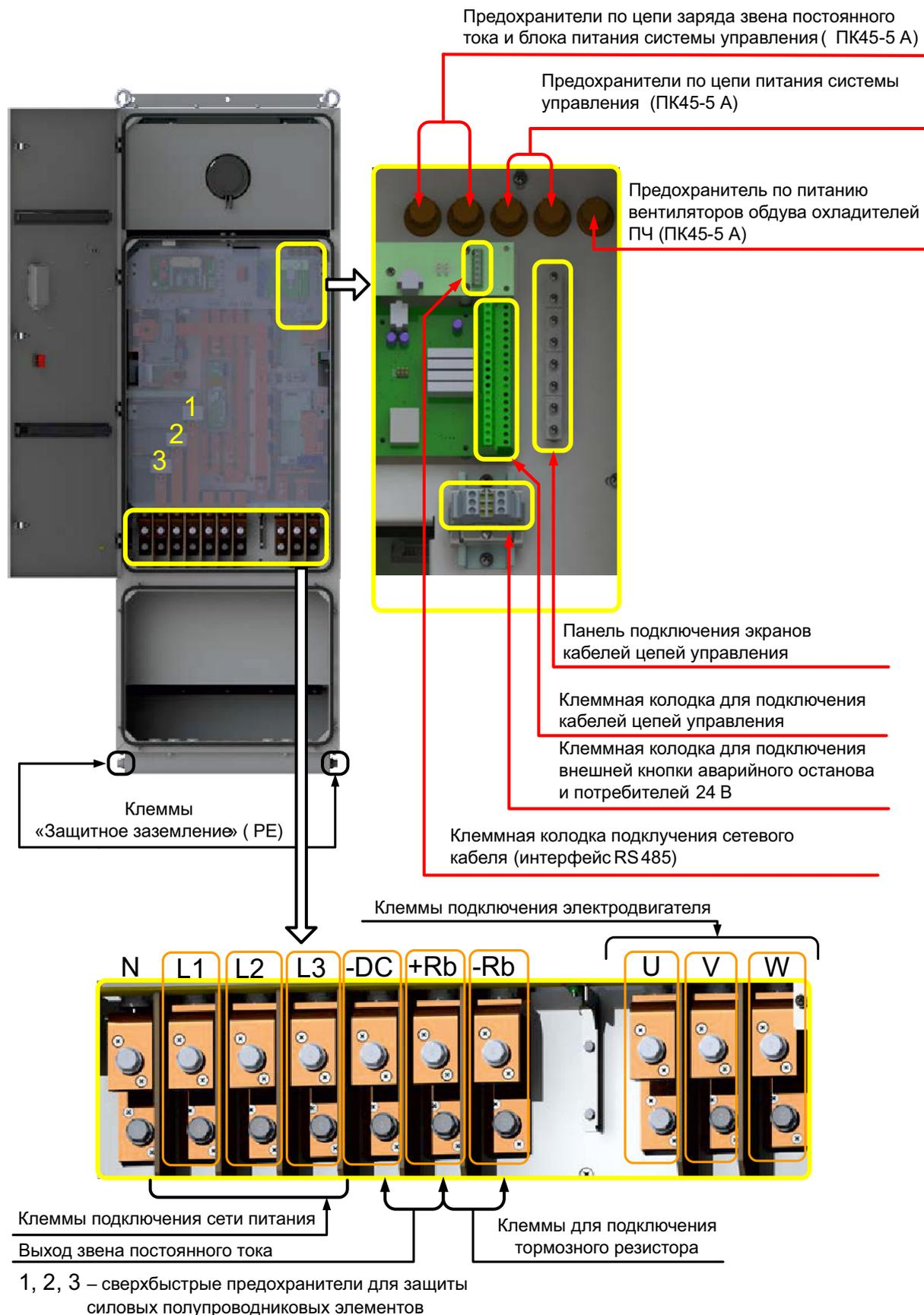
**Рисунок 5.13 — Расположение и назначение клемм электроприводов переменного тока серии Триол АТ24-М40-380-Н\*\*\*\*\***
