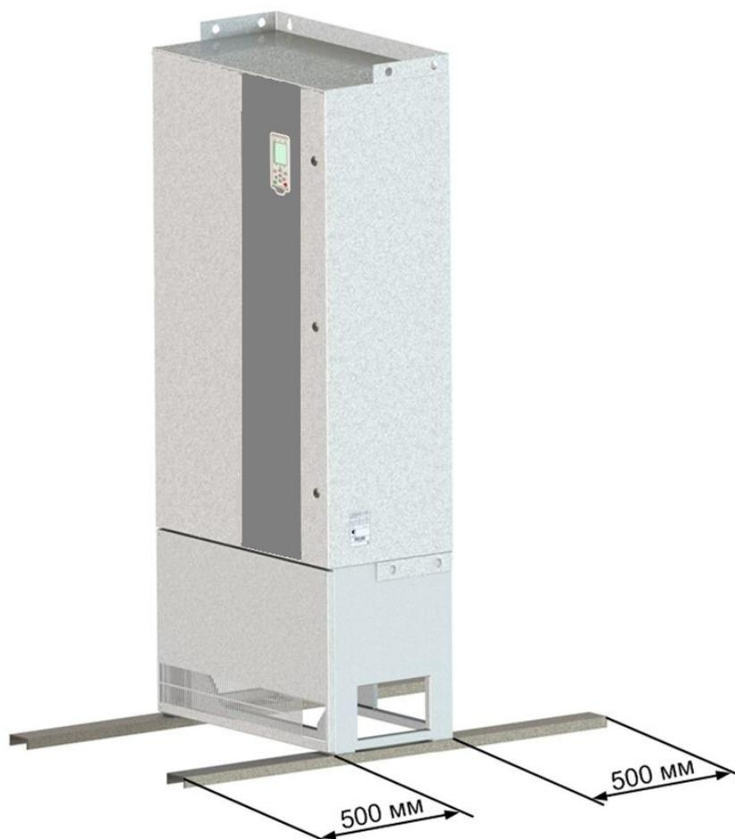
**Рисунок 5.34 — Установка электропривода на дополнительных опорах**
