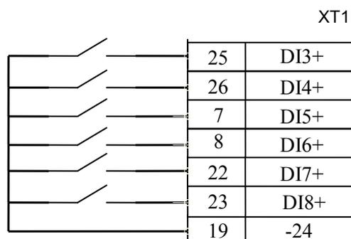
Рисунок 6.11 — Подключение при общем минусе
