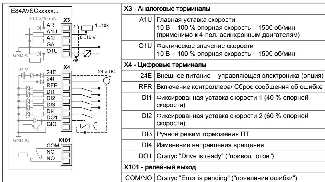
[4-2] Подключение терминалов управления / преднастроенное назначение (Lenze-настройки)
