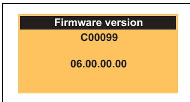
Версию ПО контроллера можно посмотреть на шильдике в строке "HW/SW" и можно определить путем прочтения кода C00099.
