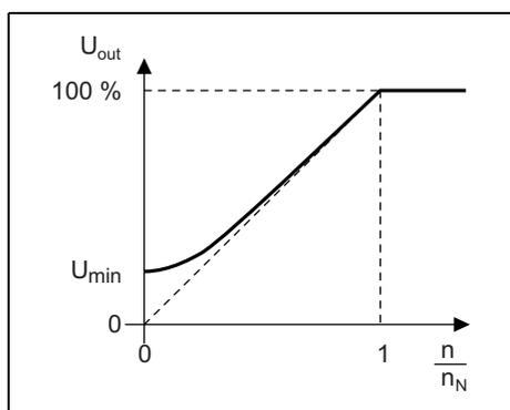
Напряжение двигателя в инверторе определяется с помощью линейной характеристики в зависимости от частоты поля или скорости вращения. Напряжение следует определенной характеристике.
